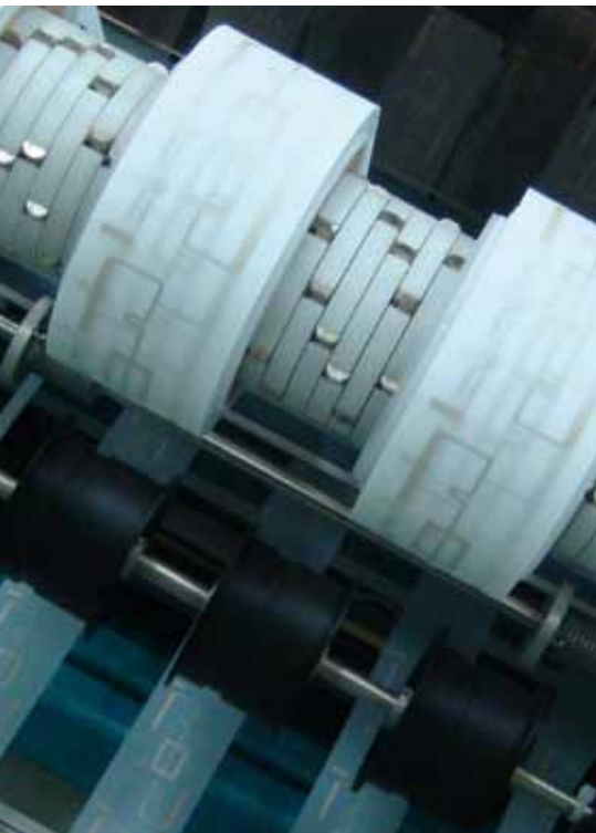
Abbildung zeigt RFID-Inlays, die mit partikelfreier Silbertinte produziert wurden.
